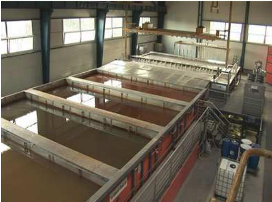
In den nacheinander folgenden Tauchvorgängen können sowohl Reinigungsstoffe als auch Korrosionsschutzmittel und Lackgrundierung in alle Ecken, Winkel und kleinste Räume der Container vordringen.
